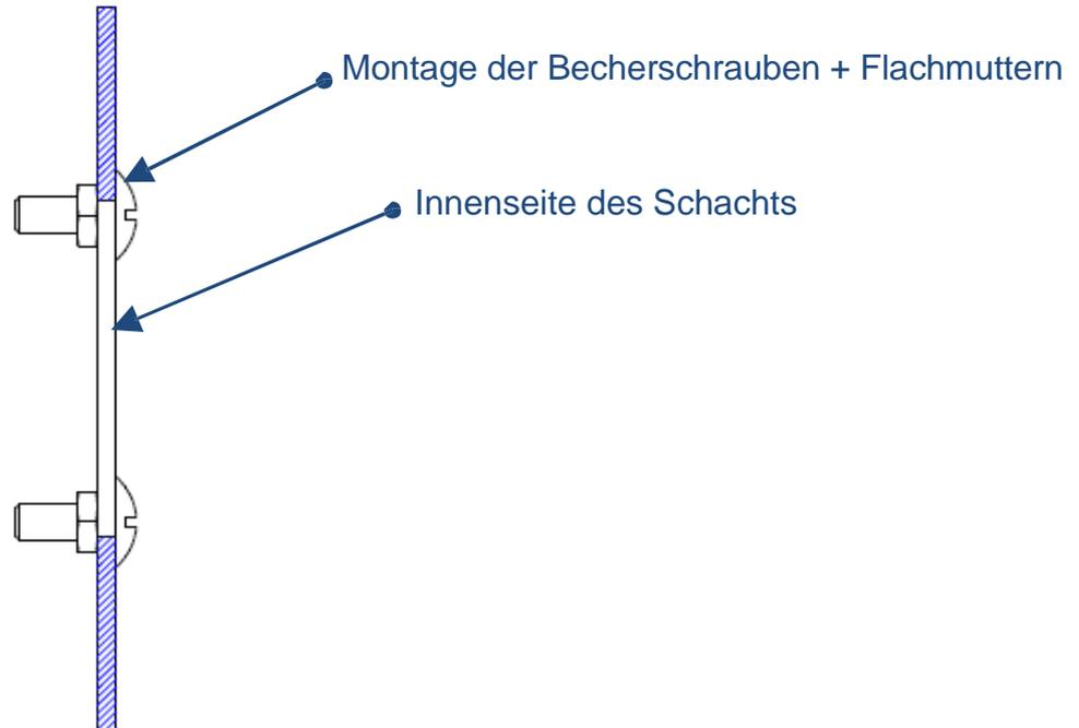
3) Die Auslösedistanz der VIGIBELT® TOUCH-Detektoren einstellen. Diese Distanz entspricht dem Abstandsmaß zwischen der Innenwand des Elevators und der Kontaktseite des Detektors.
