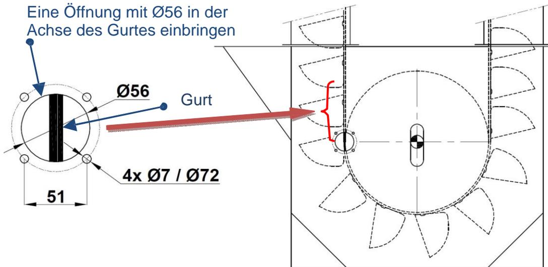
Bei einem Becherelevator die VIGIBELT® TOUCH-Detektoren an der aufsteigenden Säule in der Nähe der Achse der Riemenscheiben und des Gurtes anbringen.
